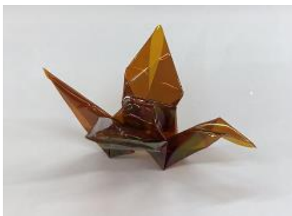
ポリイミドへ成膜して折り曲げても剥離しない強靱な密着性
